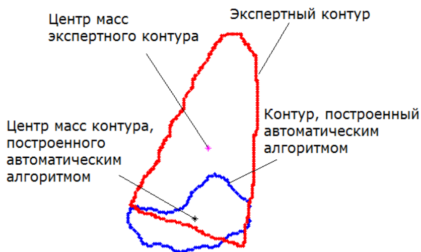
Рис. 9 Экспертный контур и контур, построенный автоматическим алгоритмом, ЦМ контуров
